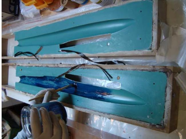
*Dépose de la résine dans le fond du moule. Vous remarquerez que la résine ne reste pas étalée (ex sur l'arrière du moule). Ce n'est pas grave. En posant le tissu, la résine reprendra sa place.*
