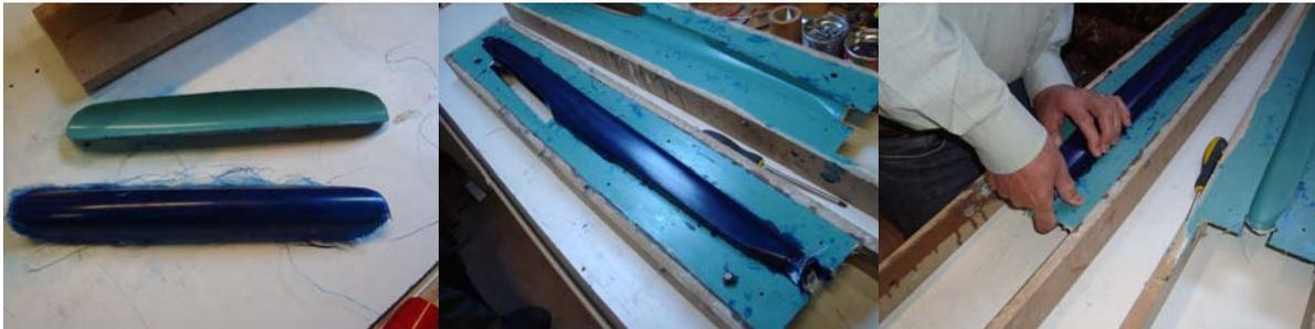
*Démoulage de la verrière, ouverture du moule et extraction du fuselage. Cela craque à chaque fois !*
