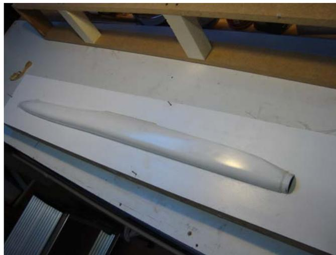
*Le master inséré, bien calé. Il ne doit pas y avoir de jeu au niveau du plan de joint.*
