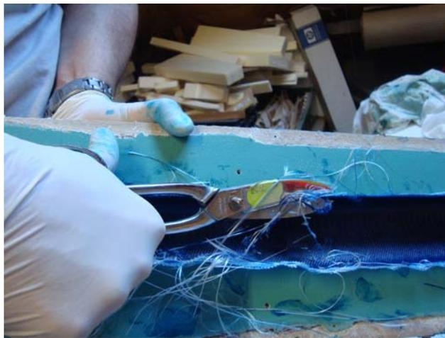
*Découpe des tissus au ras du plan de joint. Attention ! il y a un sens de passage afin que la coupe des ciseaux se fasse sur le plan de joint et non au dessus. Ici, la découpe se fait dans le bon sens.*
