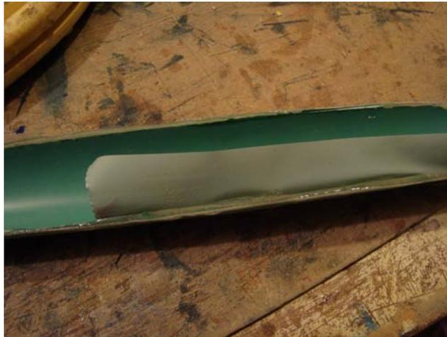
*Réparation d'un moule : Une couche de scotch et de la résine fluide. L'état de surface s'obtient sans ponçage.*
