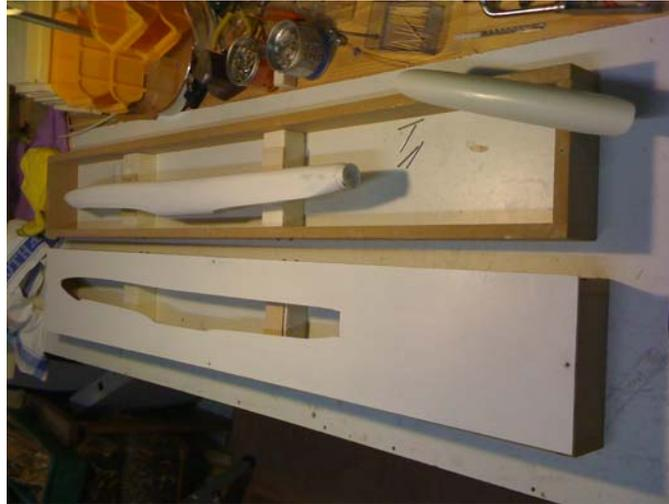
*Les deux caisses pour réaliser le moule. La plaque matérialisant le plan de joint est posée sur l'une d'elle. Des cales en polystyrène sont ajustées pour mettre le master au bon niveau.*
