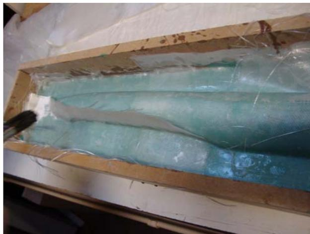
*Pose de la première couche de fibre dans le moule. Attention à ne pas insérer de bulles sous chaque couche de tissu !*
